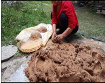
Fotoğraf 4, 5, 6: Katı çamur haline getirilen toprak; Pileki için uygun kıvamın test edilmesi. Eşit büyüklükte kunt'lar oluşturulması.
