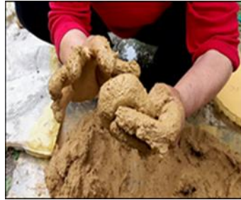
Fotoğraf 4, 5, 6: Katı çamur haline getirilen toprak; Pileki için uygun kıvamın test edilmesi. Eşit büyüklükte kunt'lar oluşturulması.
