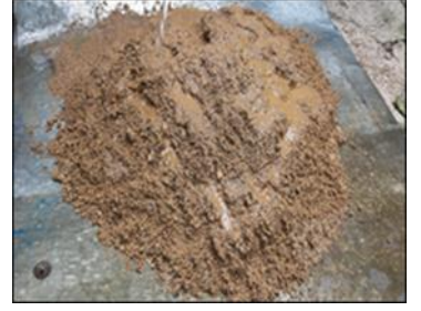
Fotoğraf 1, 2, 3: Toprağın yerinden çıkarılması; Çıkarılan toprağın elenerek temizlenmesi, su geçirmez düz zemine alınan toprağa su verilmesi.
